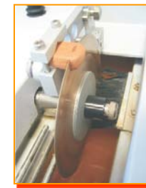
Preparación de lámina delgada
