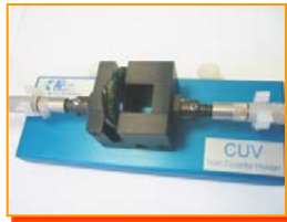
Lámina pulida en el espectrofotómetro
